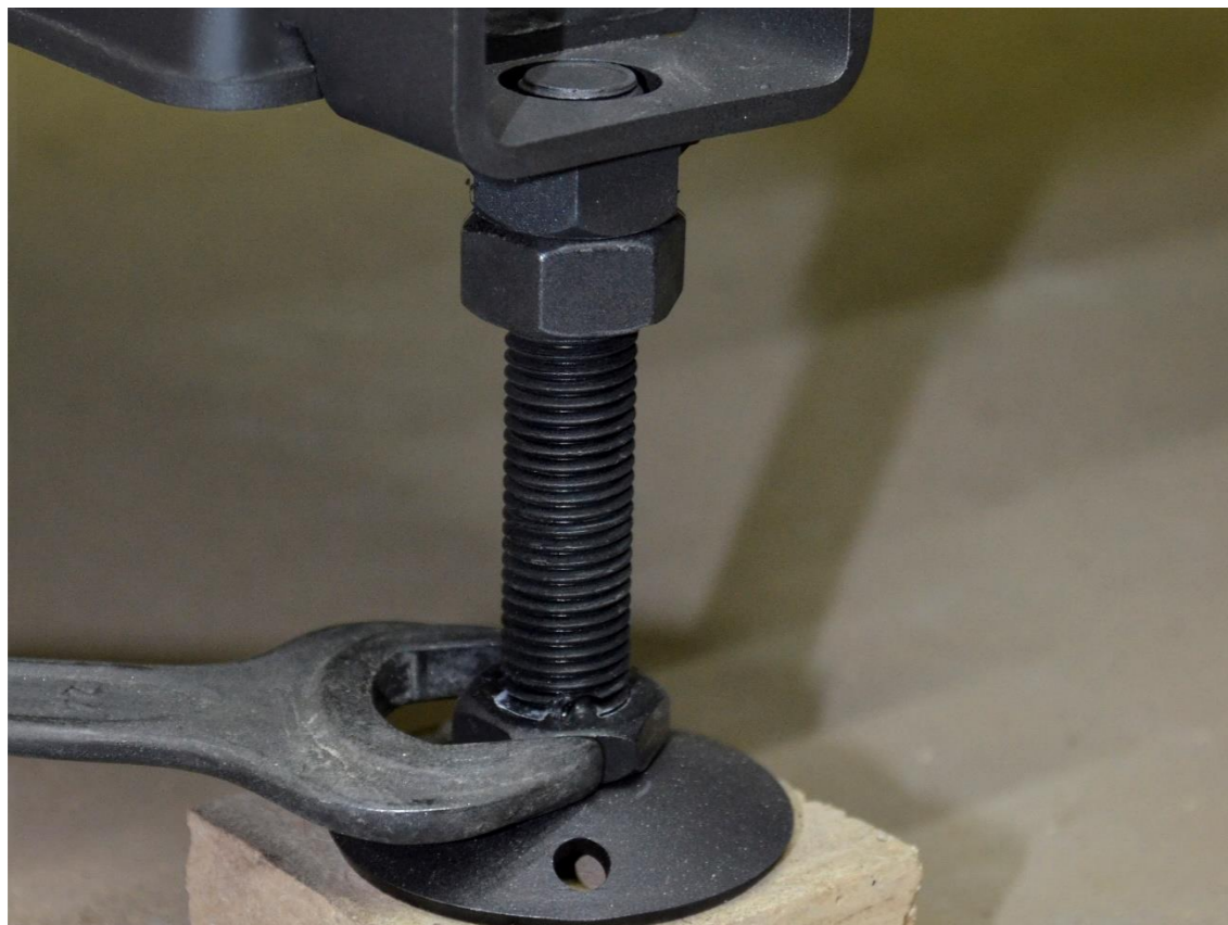
30) Výškové nastavení pomocí stavitelných šroubů.
